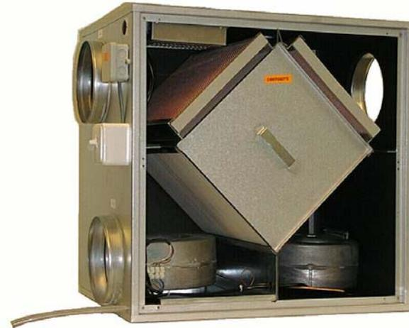
Die Abluft aus den Räumen wird durch Frischluft ersetzt, dadurch wird die Luftqualität verbessert. Im Winter wird die kältere Frischluft, mit Hilfe eines Wärmeüberträgers durch die wärmere Abluft erwärmt. Dieser Vorgang wird Wärmerückgewinnung genannt. In Variante 1 kann 80% der Wärme wieder zurückgewonnen werden. Diese zurückgewonnene Wärme muss nicht mehr durch die Heizungsanlage erzeugt werden. (siehe Abbildung 3).
