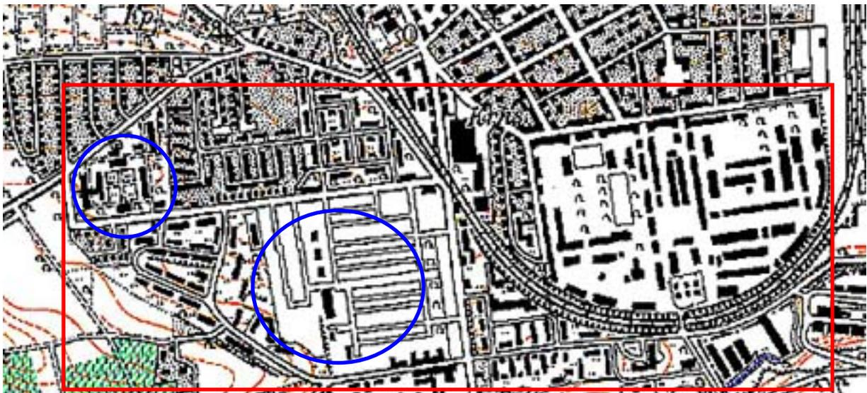
Abbildung 3.1.3: Stadtplan von Landau mit Kennzeichnung des Einzugsgebietes von Netzvariante 3 und Kennzeichnung der bestehenden Nahwärmenetze in blauer Farbe
