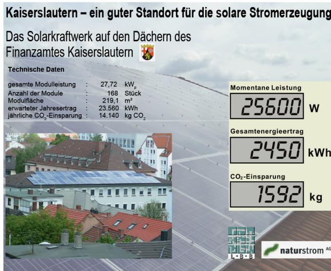
Das Anzeigemodul dokumentiert die Tages- und Gesamtleistung des eingespeisten Stromertrages.
