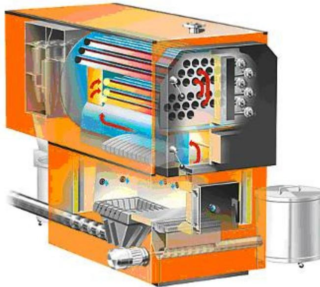
Abbildung 4-4 Biomassekessel mit Unterschubfeuerung (Quelle: Fa. Schmid AG, CH-Eschlikon)
