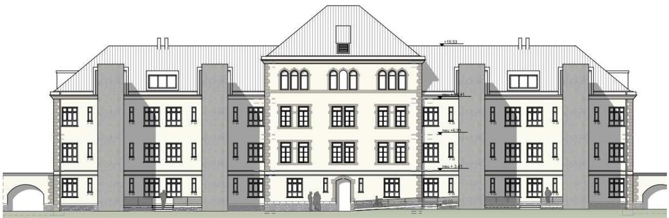
**Abb. 23: Geplante Treppenhäuser an der Nordseite des Gebäudes<sup>2</sup>**
