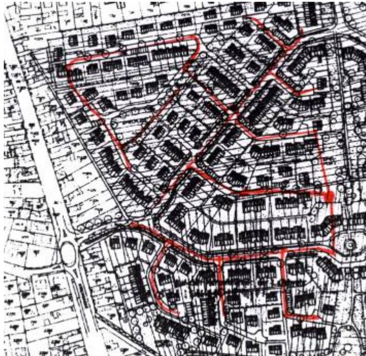
Abbildung 1-2 Lageplan 1. Bauabschnitt Neubaugebiet mit vorgeschlagenem Nahwärmenetz und Standort der Heizzentrale
