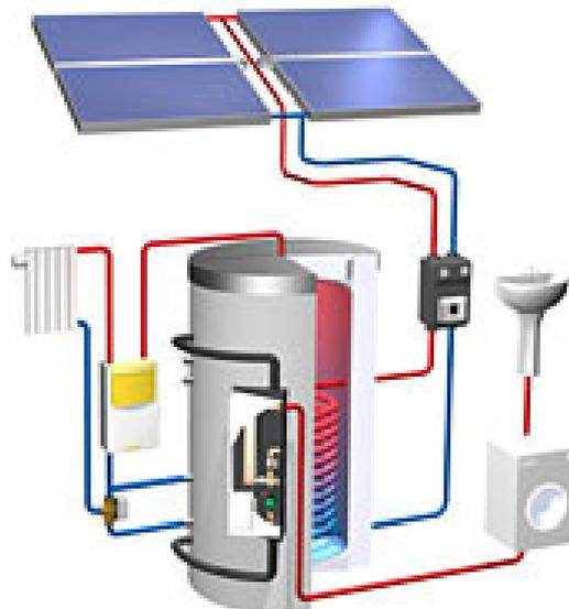
Abbildung 2-6 Schema zu solarthermischen Anlage zur Unterstützung der Trinkwassererwärmung und Raumheizung (Quelle: Wagner & Co. Solartechnik)
