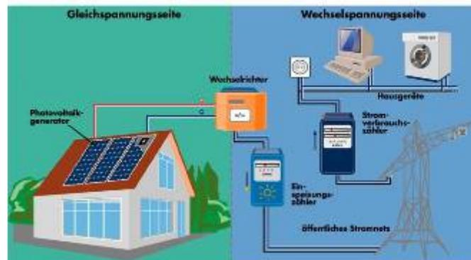
Abbildung 2-16 Schemazeichnung und netzgekoppelte Anlage (Quelle: CD Solarenergie)
