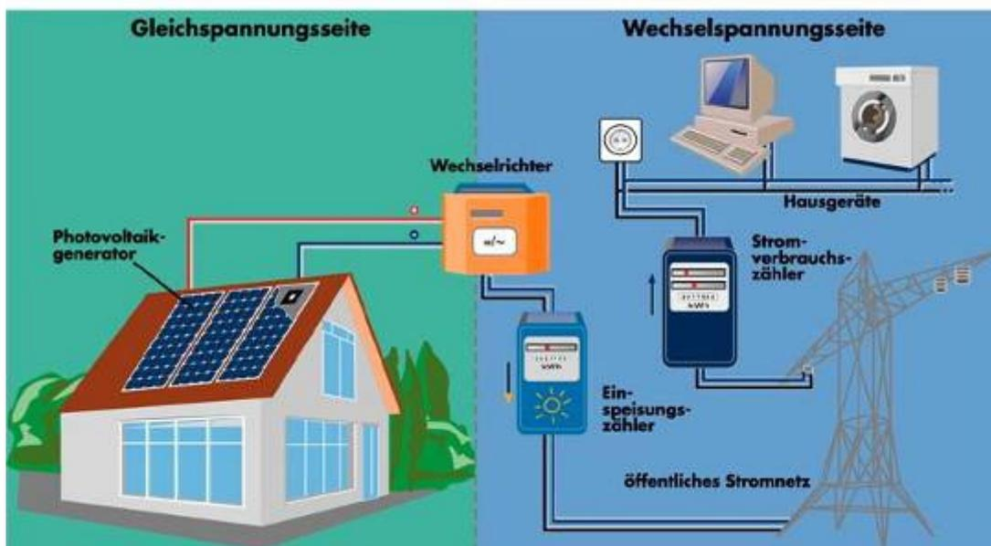
Abbildung 4-5 Eine netzgekoppelte Anlage speist den Solarstrom ins öffentliche Netz ein
