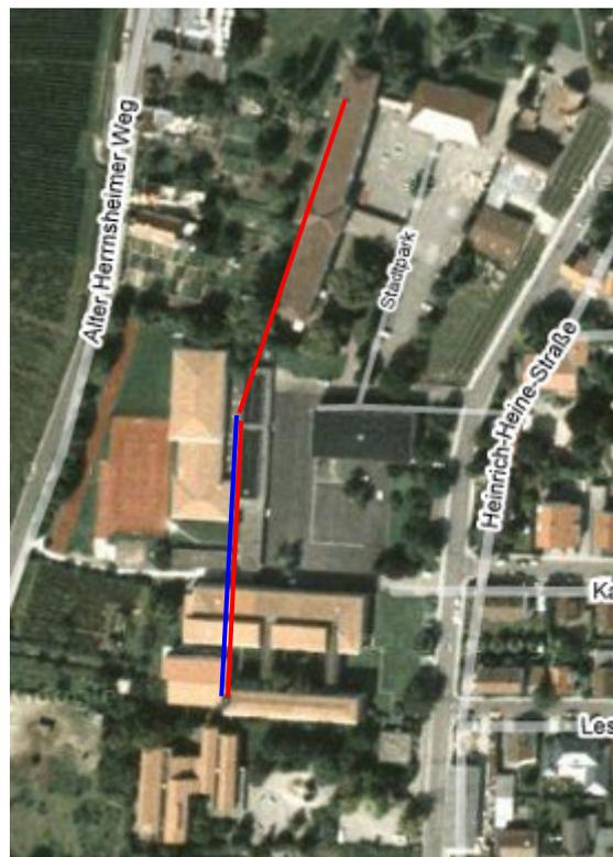
**Abbildung 3-2 Nahwärmenetz Schulen Osthofen schematisch (blau: vorhandenes Nahwärmenetz, rot: Erweiterung Nahwärmenetz)**
