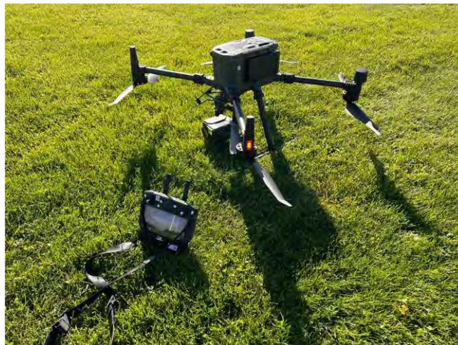
**Abbildung 2** Die Drohne DJI Matrice 300 wurde ab März 2021 in dem hier beschriebenen Projekt erstmals eingesetzt. © Drohnen- Service-Pro GmbH
