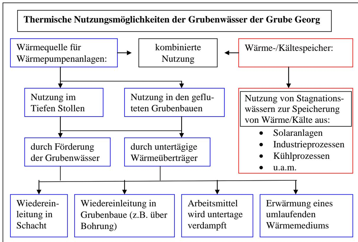
Abb. 33: Fließschema über Möglichkeiten zur geothermischen Nutzung von Grubenwässern (abgeändert in Anlehnung an HOFMANN, LAGERPUSCH & WOLF, 2007)
