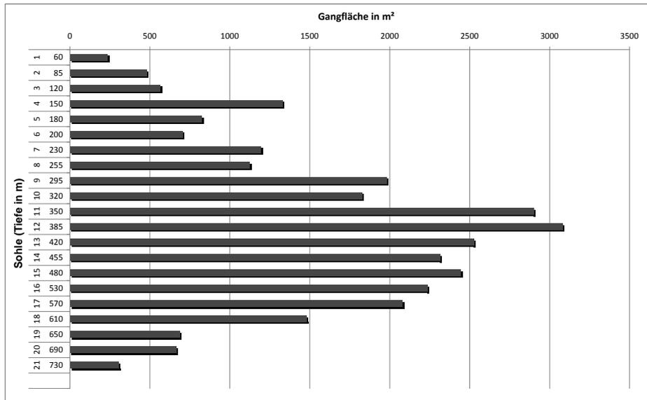
Abb.19: Gangfläche der Tiefbausohlen der Grube St. Andreas
