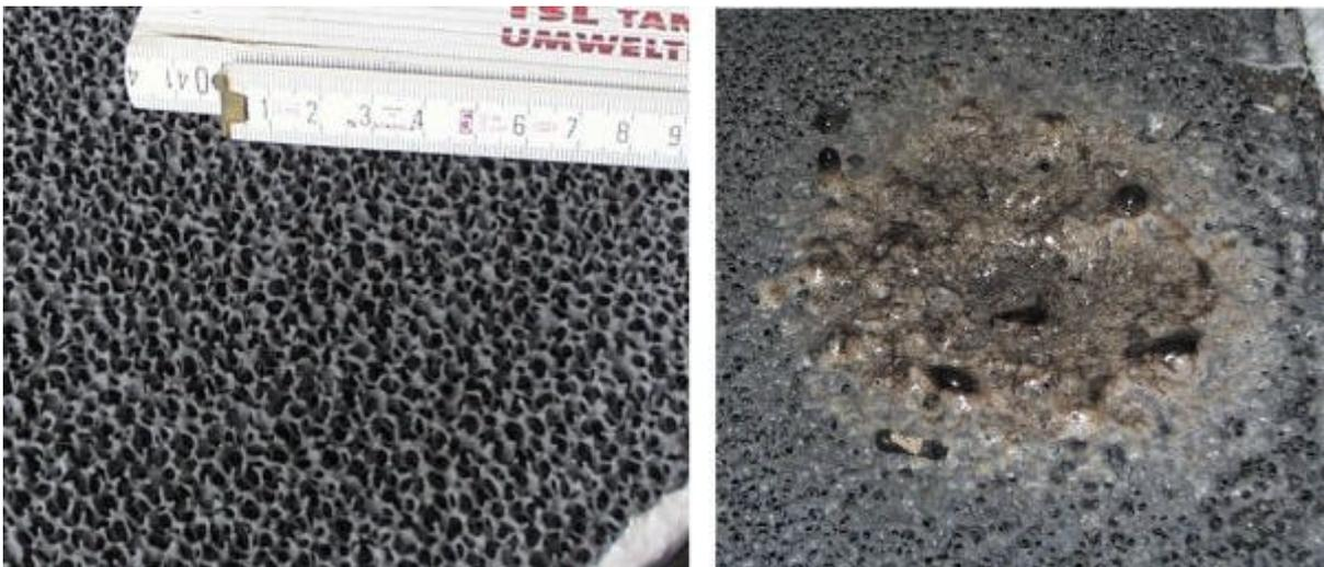
**Abbildung 24** Keramikfilter (SiC-Keramik) vor und nach Beanspruchung
