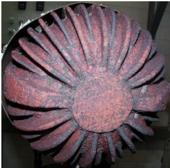
**Abbildung 34** Erhitzerkopf (neu) nach Beaufschlagung mit Rauchgas
