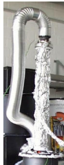
**Abbildung 29** Keramik Hochtemperatur Abgaswärmetauscher
