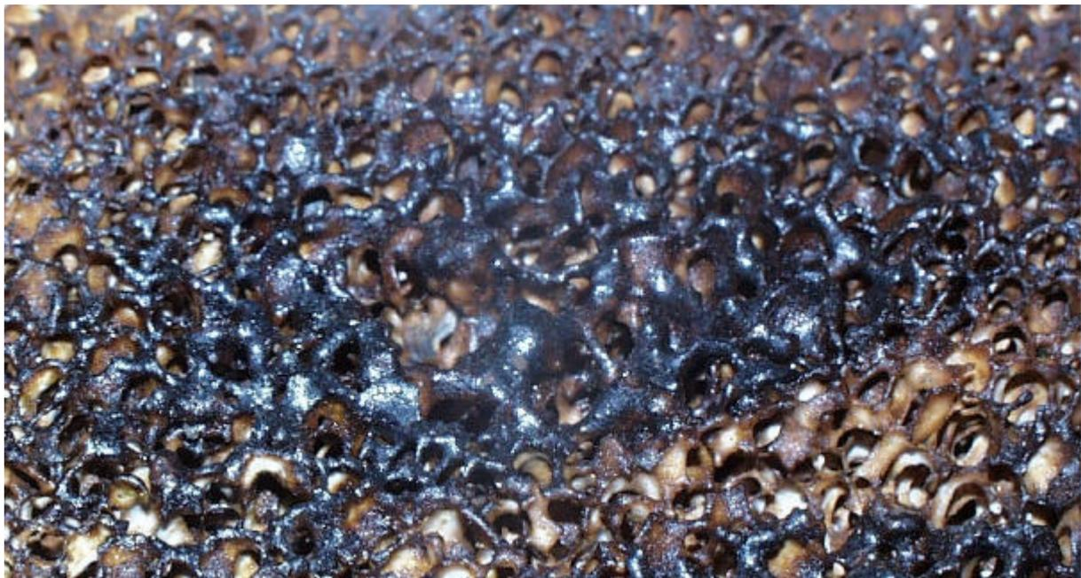
**Abbildung 22** Belegter Porenfilter Filter aus Aluminiumoxid
