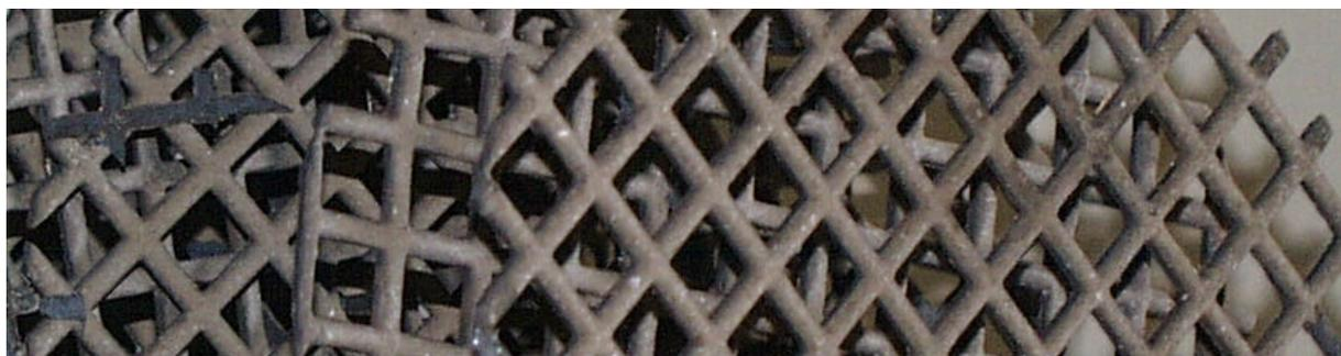
Abbildung 20 Mit Staub belegte Gittermatrix
