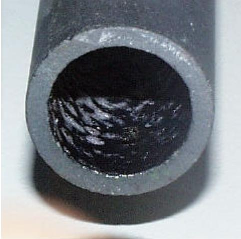
**Abbildung 30** Keramikrohr mit glasiertem Staubüberzug (innen)
