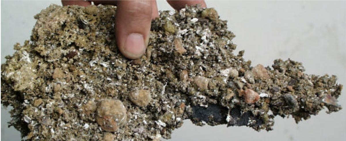
Abbildung 16 Schmelze aus der Primärfeuerungskammer
