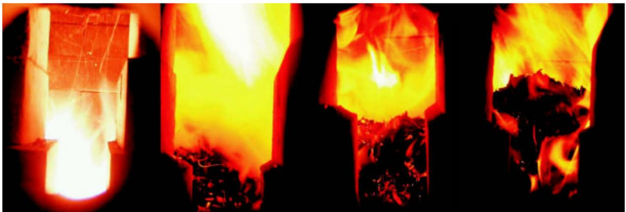
**Abbildung 15** Aufhäufung von Brennstoff auf Schrägrost
