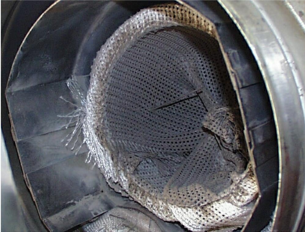
**Abbildung 23** Keramische Filtermatte aus Aluminiumoxid
