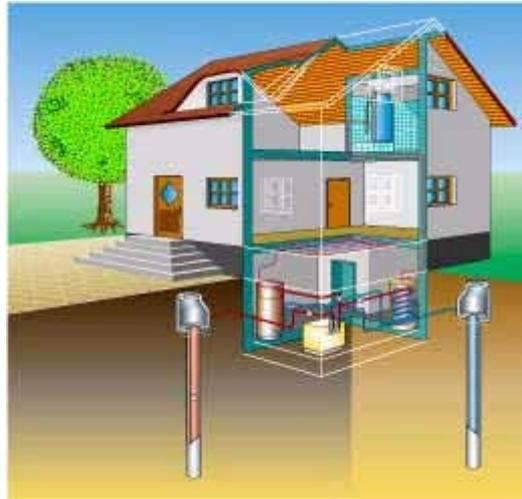
Abbildung 3-4 Wärmepumpenanlage mit Saug- und Schluckbrunnen
