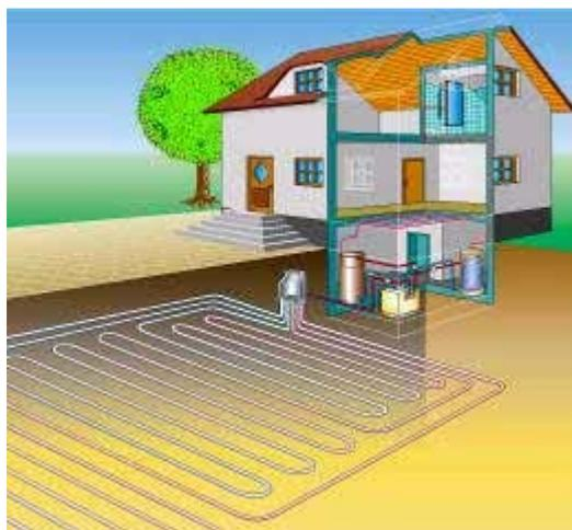
Abbildung 3-5 Wärmepumpenanlage mit Rohrschlangen
