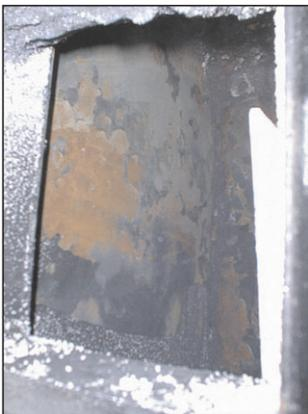
Abb. 5: Korrosionserscheinungen nach der Verbrennung von Getreide in einem Pelletkessel (Foto: BLT Wieselburg, Österreich)
