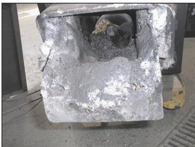
Aufgrund der geschilderten Verschlackungsgefahr sollte Getreide nie in herkömmlichen, nicht angepassten Pelletkesseln verbrannt werden. Interessierte sollten daher nur Kessel in Erwägung ziehen, die speziell für die Verbrennung von Getreide umgerüstet sind.
