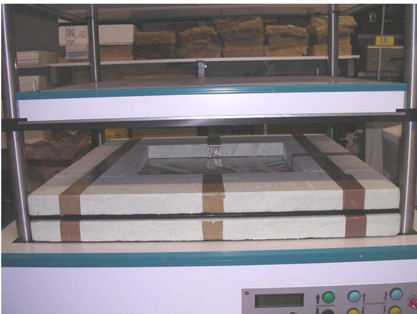
▪ *Bild 18: Oberer Probenschutzring wurde aufgelegt, Probe konnte eingebaut werden.*
