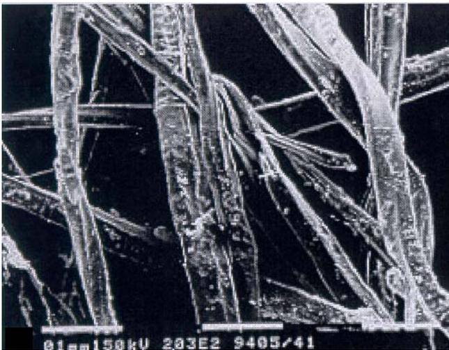
▪ Bild 3: REM-Aufnahme von TMP-Faserstoff [19]
