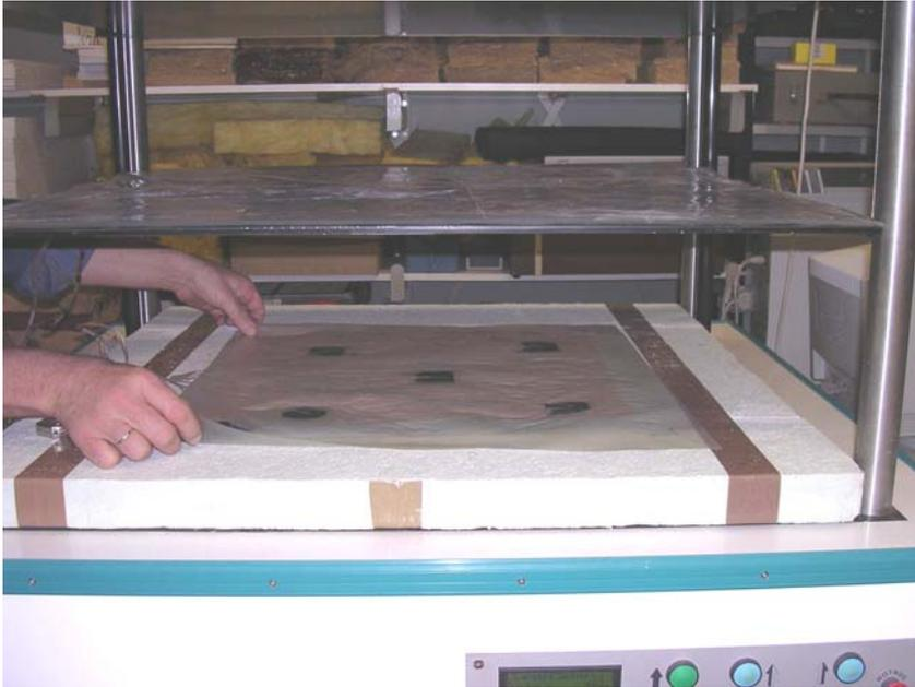
▪ *Bild 17: Auflegen der Thermoelementfolie auf die untere Probe*
