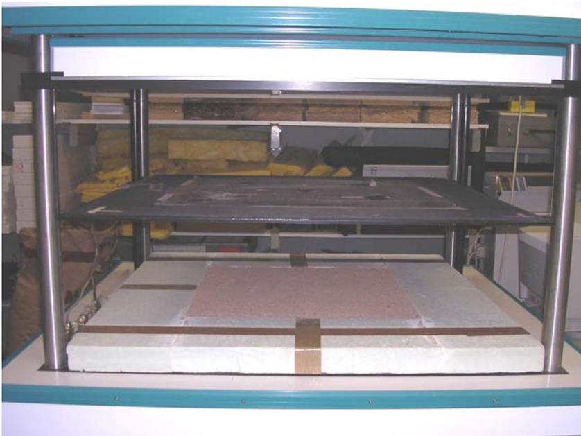
▪ *Bild 16: Untere Probe mit Probenschutzring im Zweiplattengerät*
