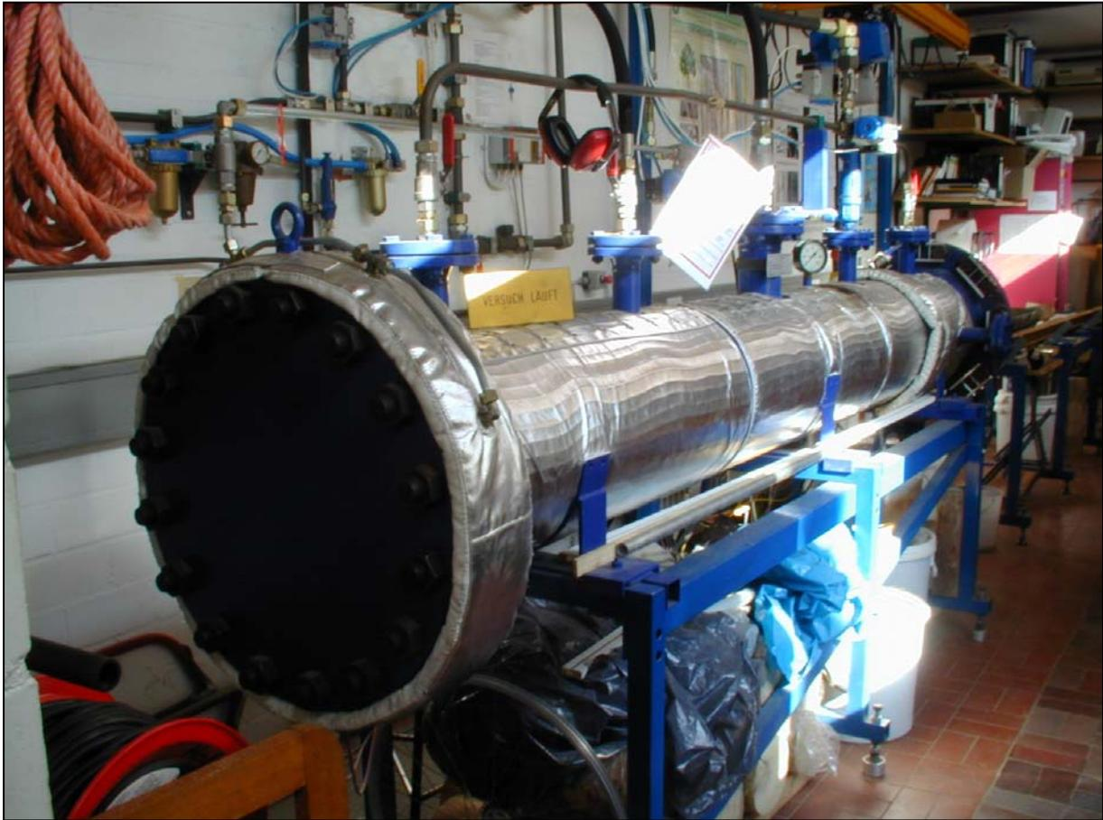
**Abb. 2:** Pilotanlage zur mechanischen Holzentfeuchtung.
