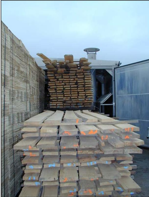
**Abb. 5:** Technisch endgetrocknetes Buchenschnittholz vor der Trockenkammer.
