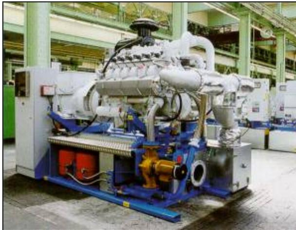
Abbildung 4-9 Hubkolbenmotor-BHKW (Quelle: MAN Dezentrale Energiesysteme)
