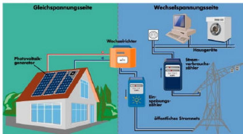
**Bild 7-3:** Eine netzgekoppelte Anlage speist den Solarstrom ins öffentliche Netz ein (Quelle: CD Solarenergie)
