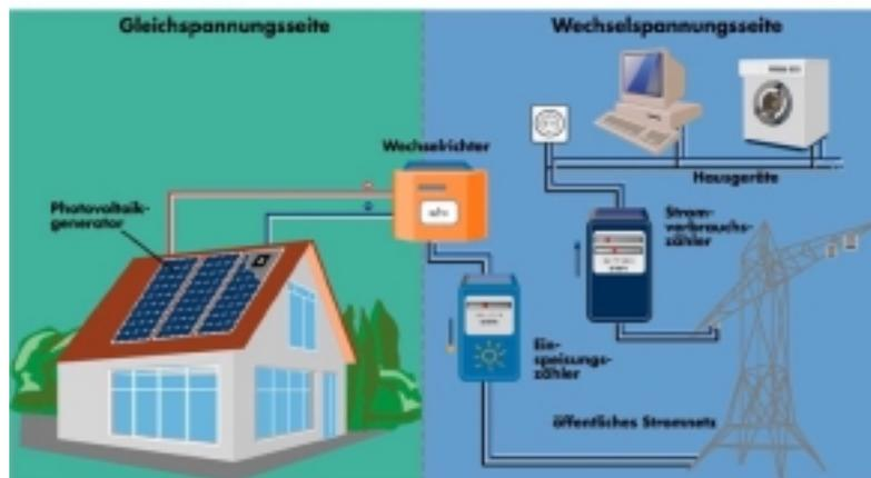
Abbildung 6-4 Eine netzgekoppelte Anlage speist den Solarstrom ins öffentliche Netz ein (Quelle: CD Solarenergie)
