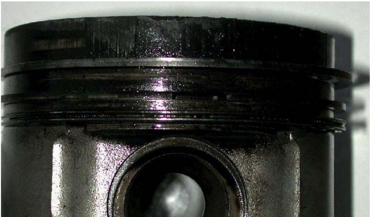
**Abbildung 5:** Kolben mit Verkokungen [Mau03]
