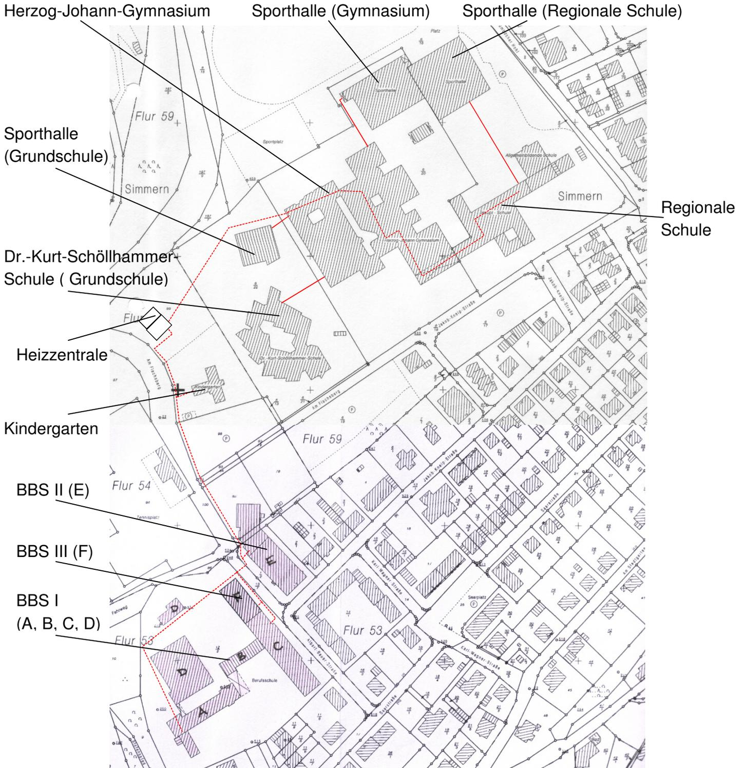
Abbildung 2-1 Lageplan mit Vorschlag Trassenführung Nahwärmenetz
