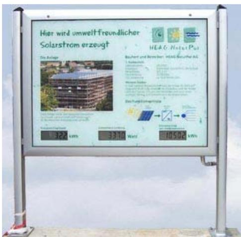
**Abbildung 21: Elektronische Großanzeige für Photovoltaiksystem**
