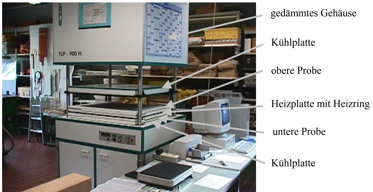
Abb. 9: Photo des Zweiplattengerätes
