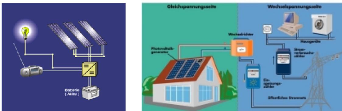
Abbildung 9-4 Schemazeichnung Inselanlage und netzgekoppelte Anlage (Quelle: CD Solarenergie)
