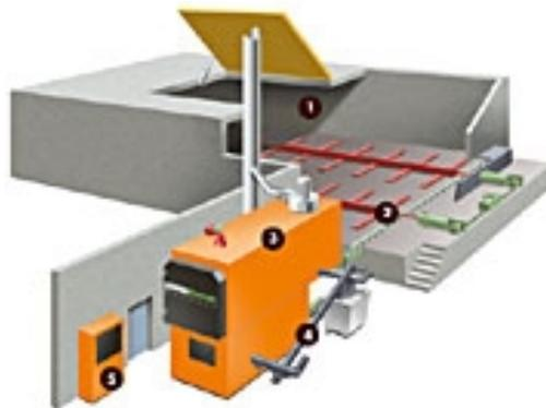
Abbildung 2-1 Biomassekessel mit Schubbodenaustragung (Quelle: Fa. Schmid AG, CH-Eschlikon)
