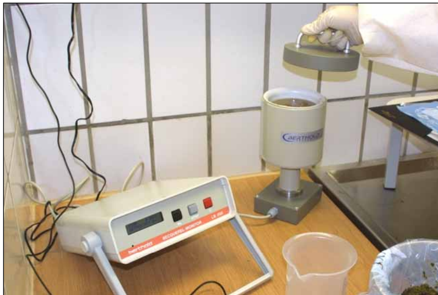
Abbildung 6: Der Aktivitätsmessplatz „LB 200“ diente der Bestimmung der Radiocäsiumbelastung der Mageninhalte. In der hinteren becherförmigen Messvorrichtung befand sich der Detektor. Ihn umgibt eine auswechselbare Ringschale, in der sich 500 ml Probenmaterial befinden.
