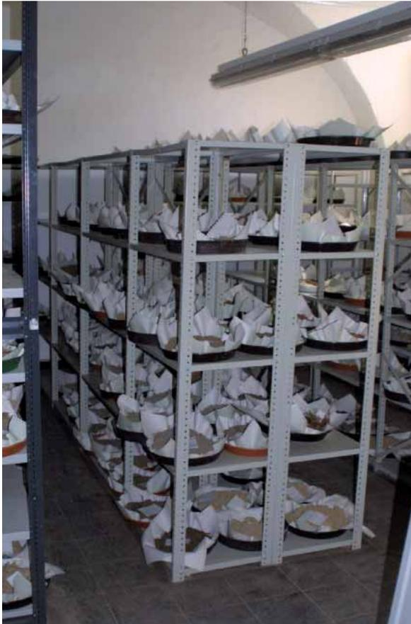
Foto 8: Lufttrocknung der Bodenproben
