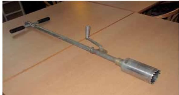
Foto 2: „Murach'scher“ Bohrer zur Humus- und Mineralbodenbeprobung an den Satellitenpunkten
