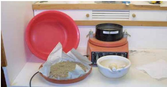
Foto 9: Arbeitsplatz zur Siebung der Bodenproben
