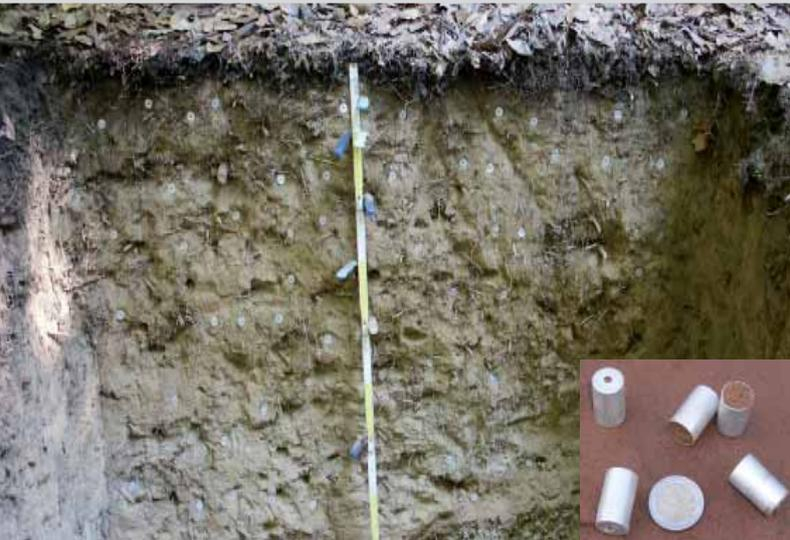
Foto 5: Einsatz von Alu-Steckkappen zur Ermittlung der Trockenrohddichte
