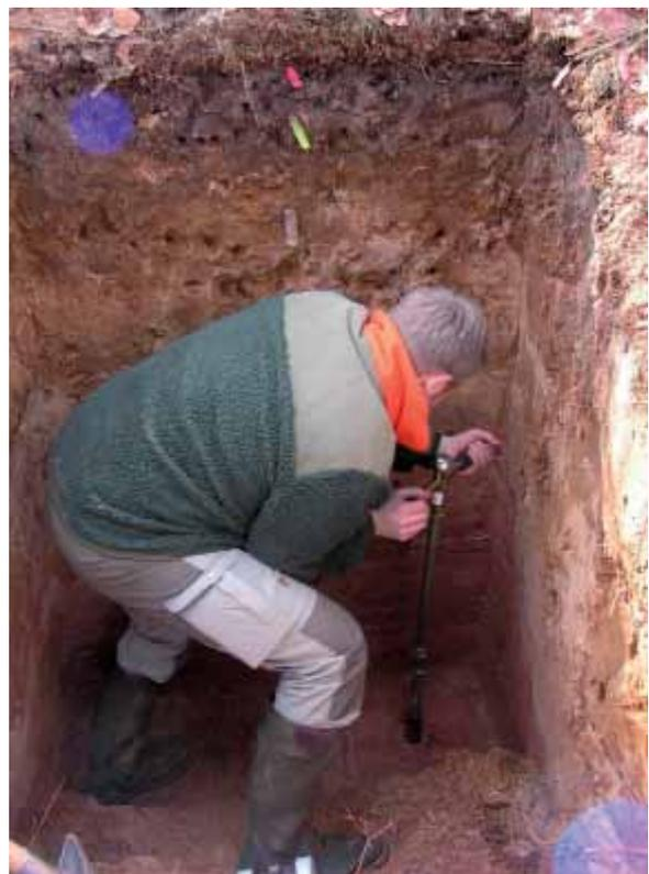
Foto 4: Bodenprobennahme unterhalb der Profilsohle
