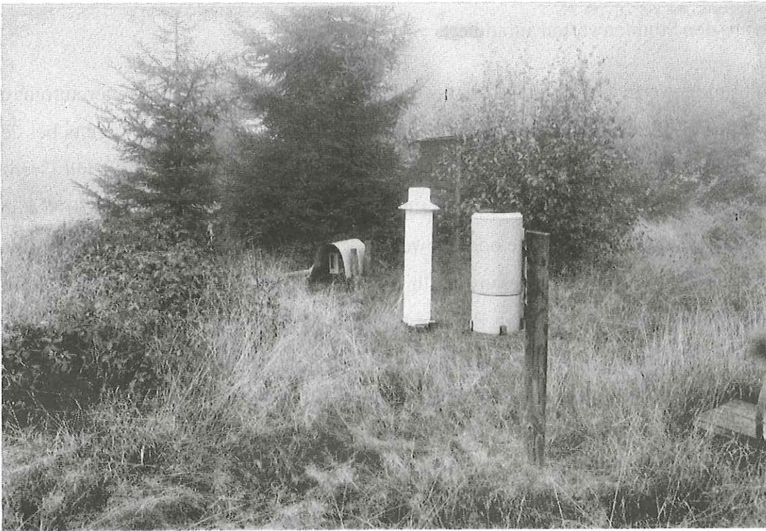
**Abb. 3:** Forstmeteorologische Freiland-Meßstation mit schreibenden Geräten im Forstamt Entenpfehl
