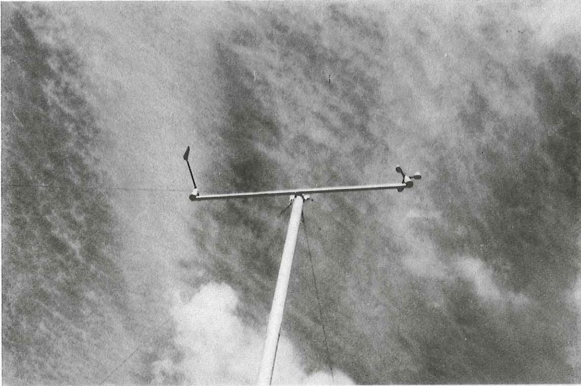
**Abb. 15:** Windrichtungsgeber (Windfahne) mit Impulsübertragung und Schalensternanemometer mit optoelektronischer Rotationsbestimmung
