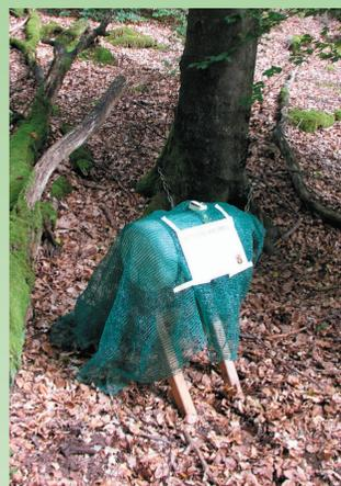
Figure 3 : Un support avec un collier GPS
