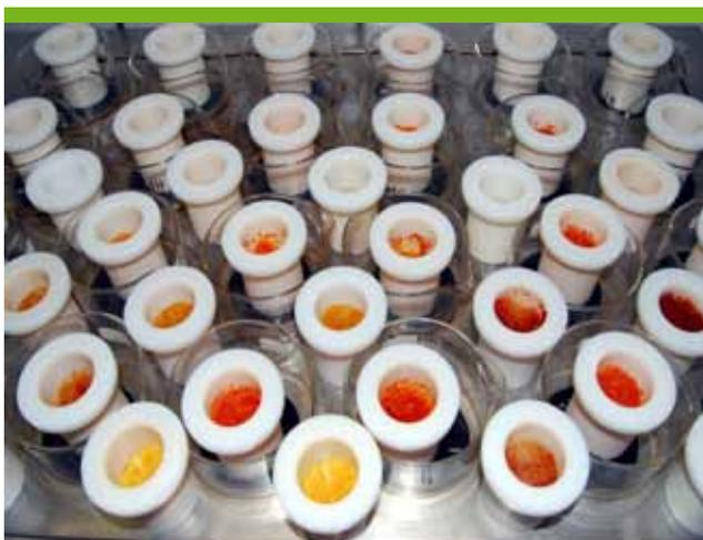
**Aufschluss von Pflanzenproben mit konzentrierter Salpetersäure zur Elementbestimmung.** Zu sehen sind die Aufschlussgefäße aus Teflon mit eingebrachtem Probenmaterial und Säure bei der Vorreaktion auf einem heißen Wasserbad. Anschließend werden die Gefäße verschlossen und der Aufschluss über Nacht bei 170°C unter Druck zu Ende gebracht
