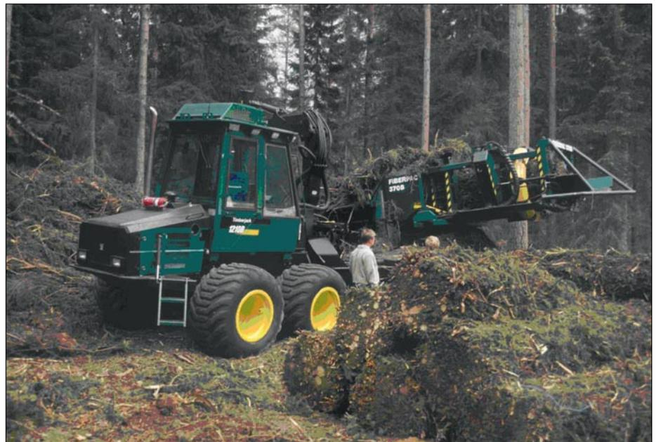
Abb. 1: Mit dem Bündler wird Kronenmaterial (einschließlich der grünen Nadeln) zum Abtransport aus dem Wald bereitgestellt. Solche extremen Nutzungsformen sollten nur angewandt werden, wenn ein massiver Nährstoffzug tolerierbar oder sogar erwünscht ist (z.B. Nutzung von Straßbegleitgrün, Freihaltung von Naturschutzflächen).
