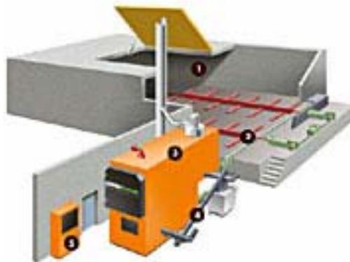
Abbildung 2-1 Biomassekessel mit Schubbodenaustragung (Quelle: Fa. Schmid AG)
